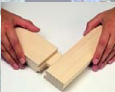
A rés-csap kötés megakadályozza, hogy felülről víz szivárogjon a keretbe.
